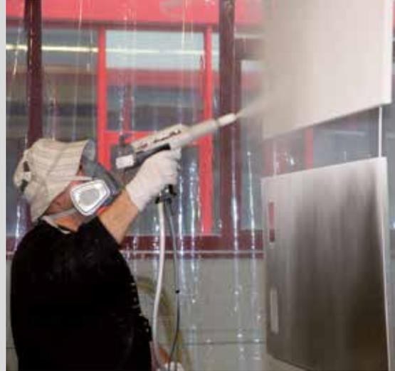
*Individuelles Finish nach Kundenwunsch: Pulverbeschichtung ermöglicht hochwertige, widerstandsfähige Oberflächen in den unterschiedlichsten Farbtönen und Strukturen.*
