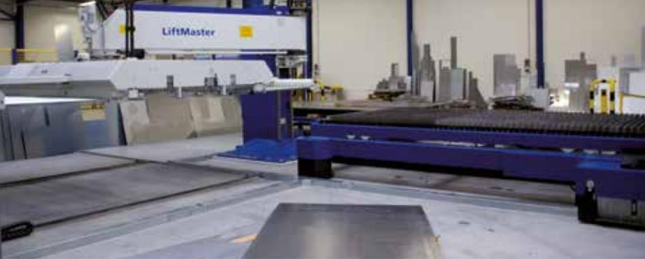
*Unsere Laserschneid-anlage ist mit einem leistungsfähigen Blech-handlingsystem ausgerüstet.*
